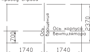
Схема расположения виброизоляторов на правой раме привод справа
